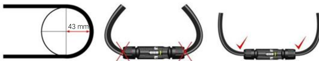
图5. 电缆的最小弯曲半径。
