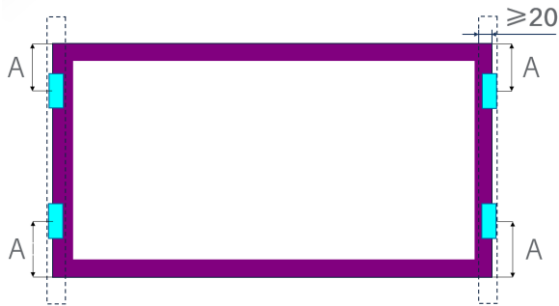
共用梁短边夹具安装，安装导轨垂直于长边 共用梁与组件短边重叠宽度应不小于20mm
